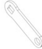
F04 LINKAGE STRAP - A4M02225 (x2) 1/8"x13/16"x2 5/8" (3x20x66)
