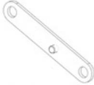
F03 LINKAGE STRAP - A4M02229 (x2) 1/2"x11/16"x3 13/16" (13x17x97)
